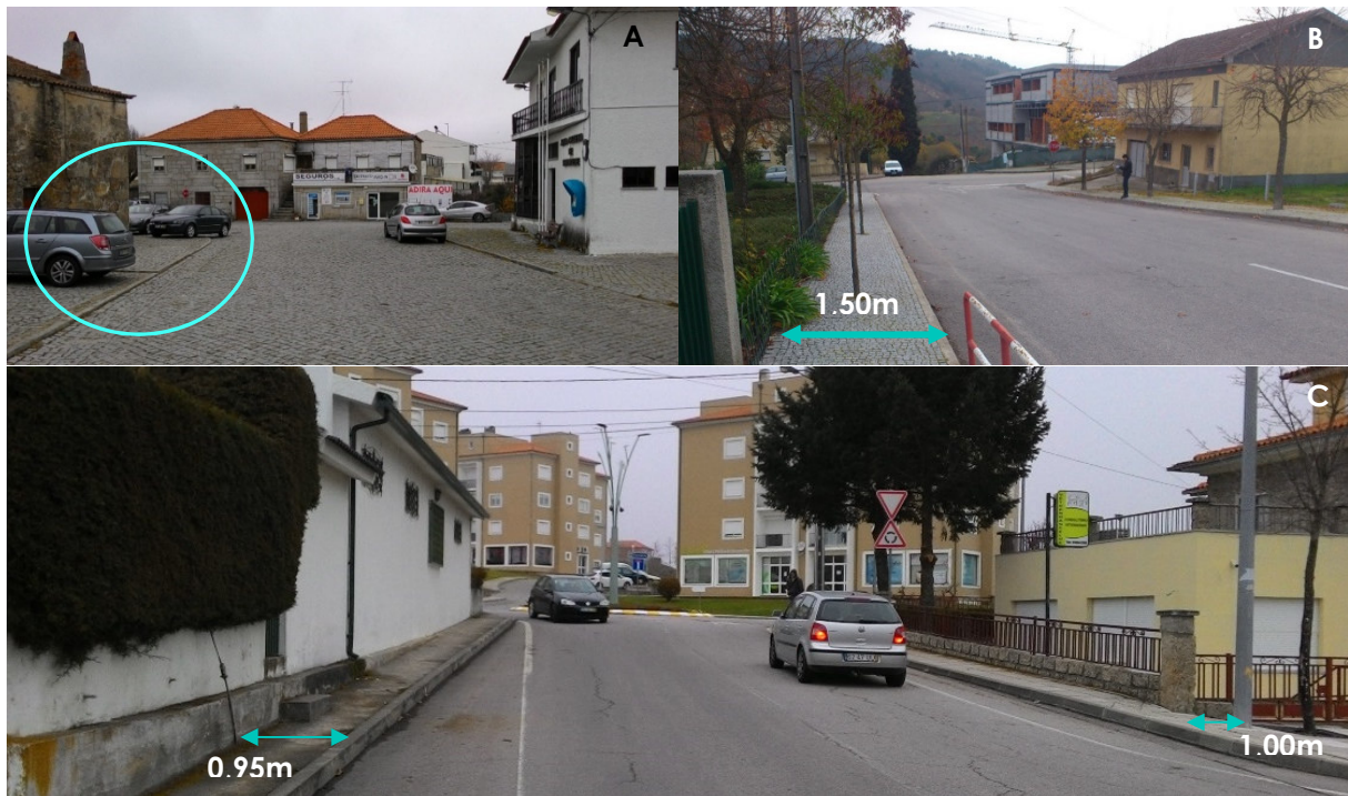
Figura 56: A - Largo Aquilino Ribeiro – Carros estacionados em cima do passeio | B - Rua de Acesso ao Exposalão – largura insuficiente dos passeios | C - Rua do Colégio – subdimensionamento das caldeiras
