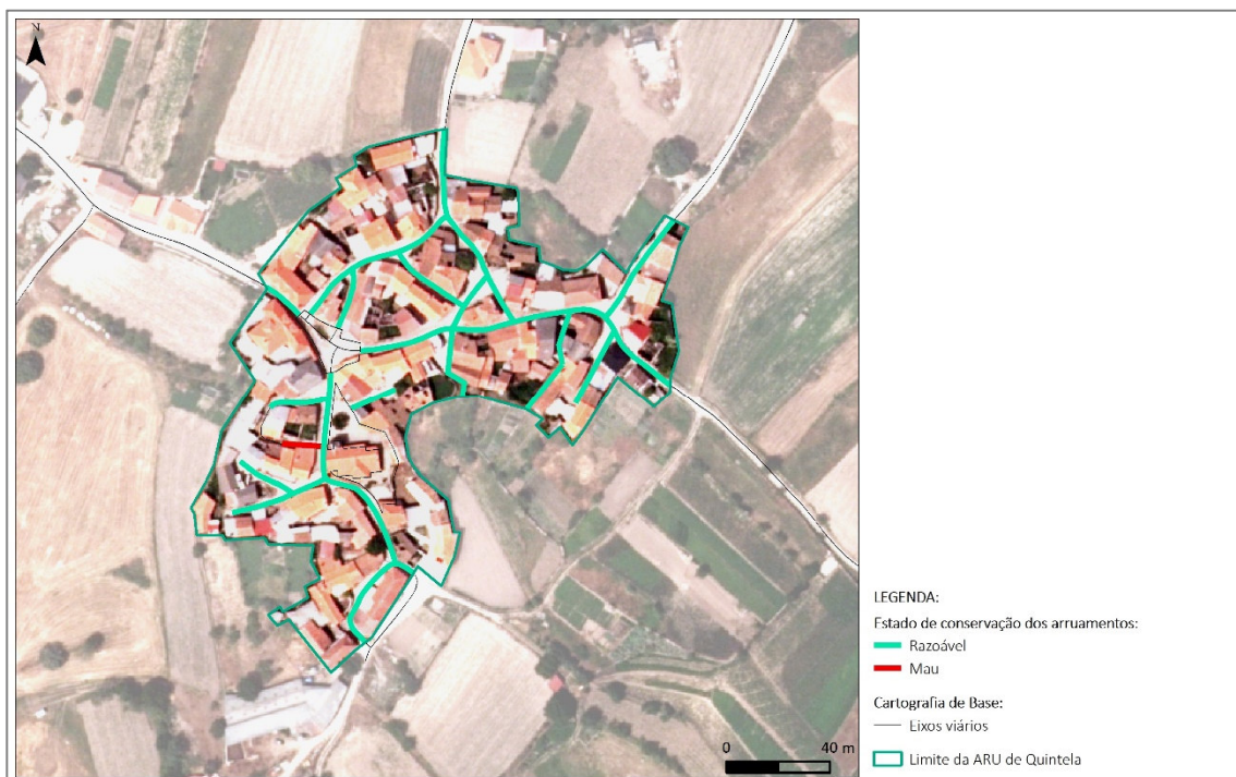
Figura 8- Estado de conservação dos arruamentos na ARU de Quintela
